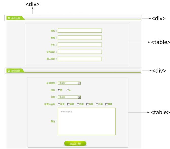
图 2-2-52 “内容”模块结构图
