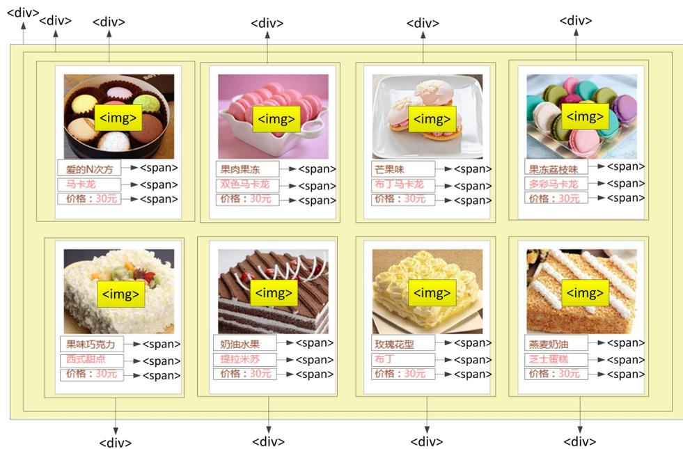
图 2-2-33 “产品展示”模块结构图
