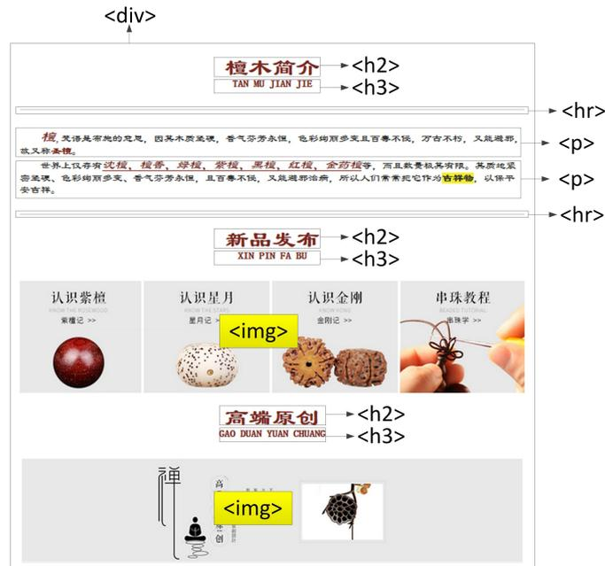
图 2-2-21 “内容”模块结构图
