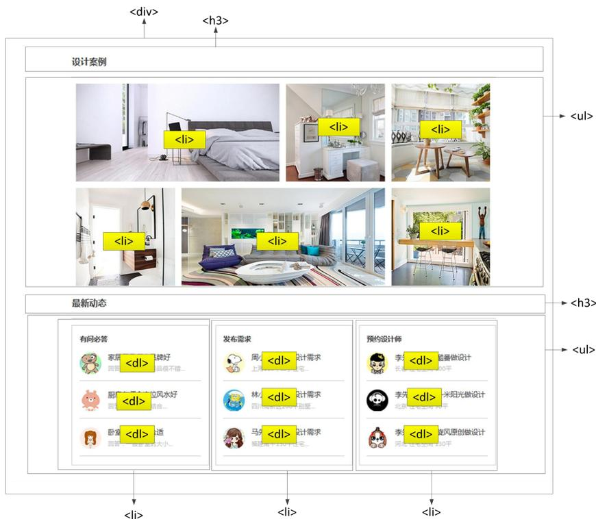
图 2-2-27 “内容” 模块结构图
